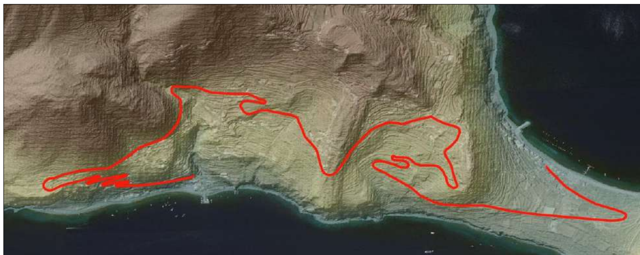
Figura 6 – Ricostruzione 3D dell'area oggetto di intervento (in rosso la strada oggetto di intervento) di Pecorini a mare. Nella figura 6 la morfologia accidentata è resa evidente dalla ricostruzione 3D tramite Lidar 1 x 1 metro in sovrapposizione al tracciato stradale attraverso elaborazione con software GIS (in rosso la traccia della strada).
